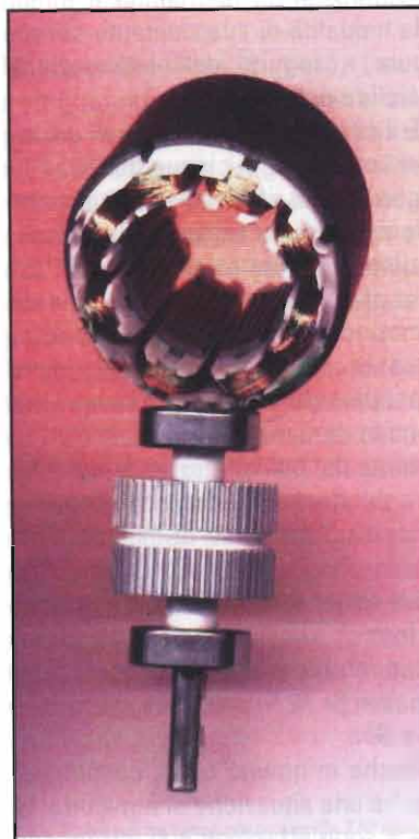
Statore e rotore di un passo passo ibrido 0.9°/step
